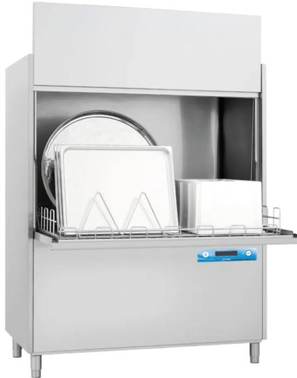
RIVER 348 merupakan mesin pencuci peralatan dapur dengan rak stainless steel berukuran 131 x 70 cm dan tinggi bukaan pintu 85 cm. Mesin ini dilengkapi antarmuka pengguna baru dengan tombol sentuh lembut dan layar LCD polikromatik terbaru. Strukturnya dibuat sepenuhnya dengan dinding ganda dan tangki yang ditekan, serta dilengkapi filter stainless steel terintegrasi. Ruang pencuciannya bebas dari pipa internal dan sudut tajam.
